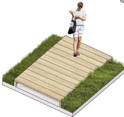
Дорожки из деревянного настила над уровнем земли
