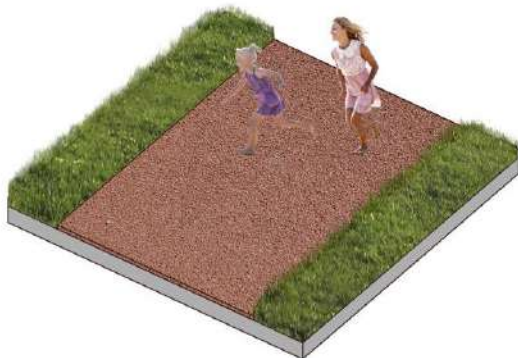
Дорожки с покрытием из гранитного отсева
